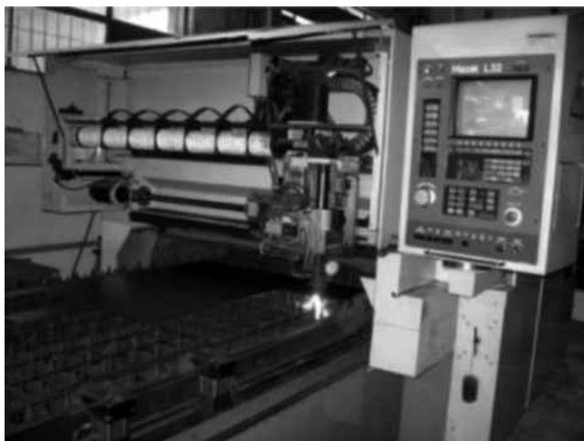
Láser industrial de CO 2 para corte y perforado instalado en el CIOp en 1988.
